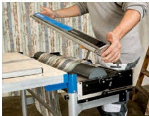
Durch Umklappen der beiden vorderen Ecken wird eine kleisterfreie Handhabung gewährleistet. Die gewünschte Bahnlänge wird über einen Meterzähler abgelesen und mit einem Rollmesser abgelängt. Die nach dem Schneiden zurückfallende Tapete wird von Tapetenabhebern aufgefangen, sodass sie nicht mit Kleister verunreinigt wird.
